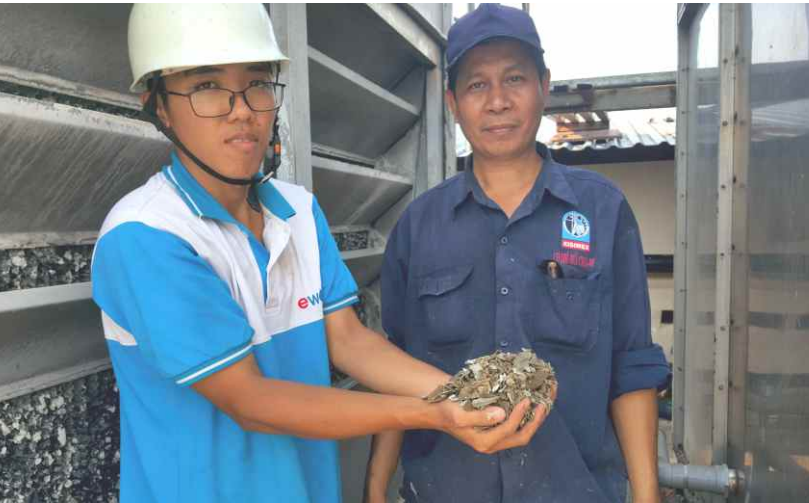
Cáu cặn lấy từ condenser của chiller
